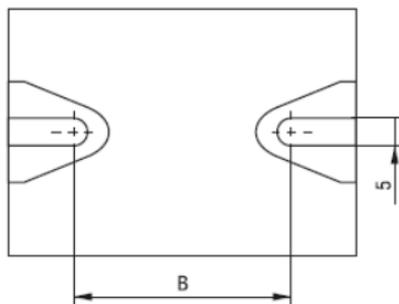
Рисунок 3 – Установочные размеры шин / Figure 3 – Busbar mounting dimensions
