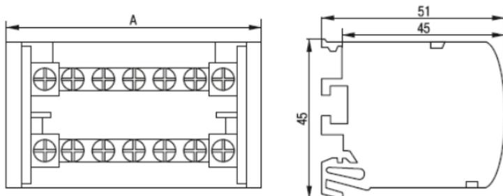
Рисунок 1 – Габаритные размеры шин ШНК 2×7, ШНК 2×11 и ШНК 2×15 /
